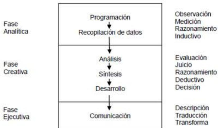
*Ilustración 45 Etapas del proceso de diseño según Archer Elaboración propia (1963)*
