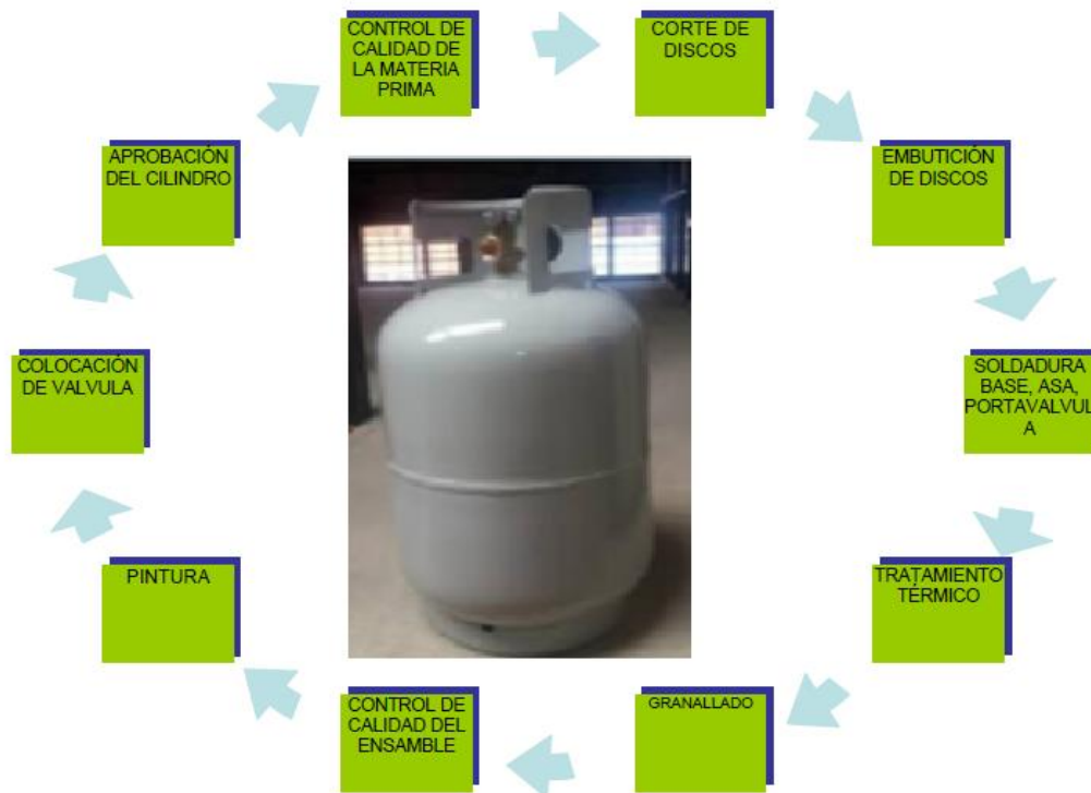
Figura 29. Principales Procesos en la fabricación de cilindros de gas
