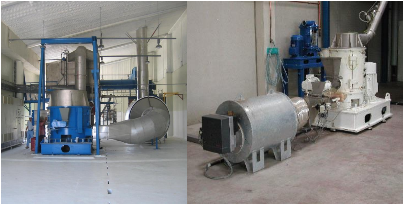
Figura 27. Calentador de aire. Fuente: Görgens, Rauscher-Holstein (página web)
