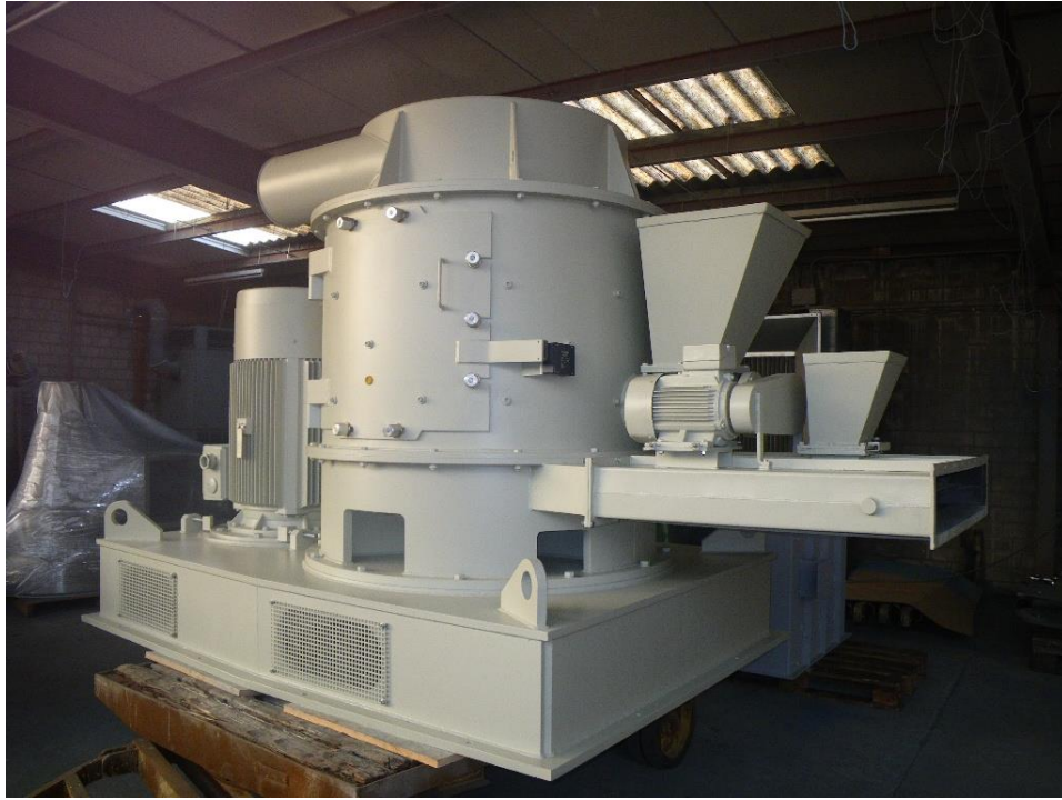
Figura 26. Turbo rotor. Fuente: Rauscher-Holstein (página web)
