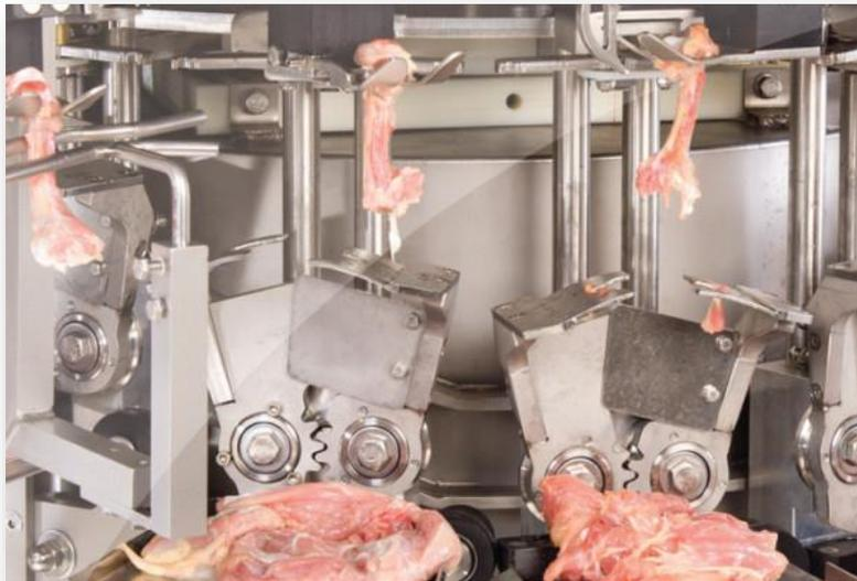
**Figura 20 Proceso Deshuesado en máquina**
