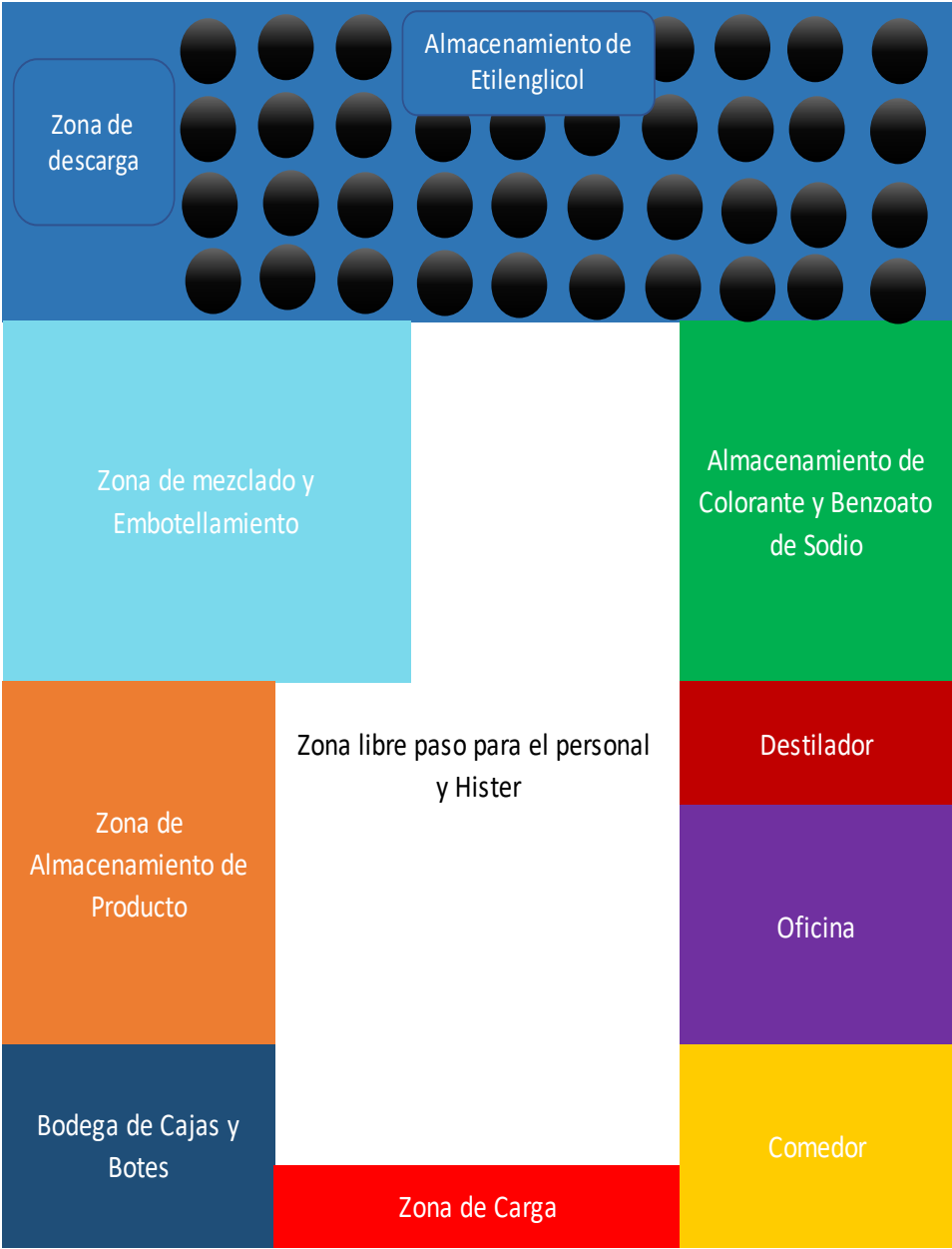
Figura 4. Distribución de la planta
