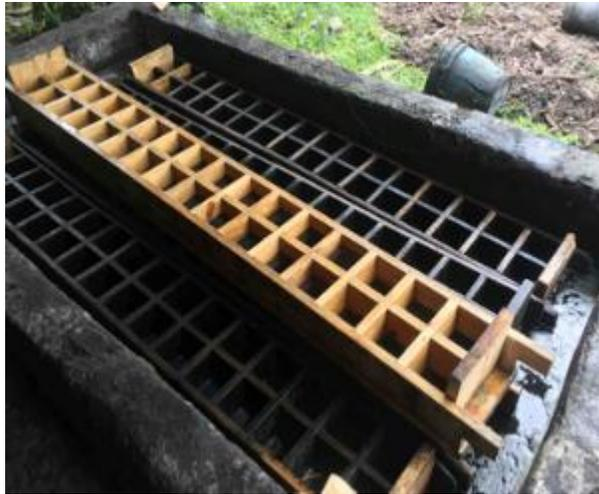
**Figura 24. Moldes para la panela**
