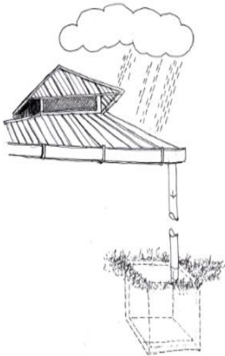
Figura 128. Captación de aguas lluvias
