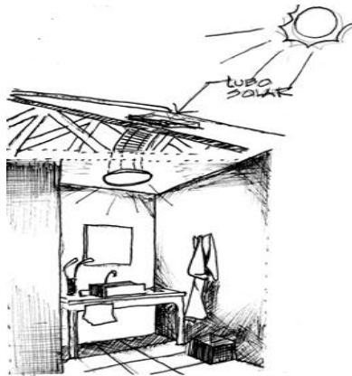
Figura 29. Vista interior ducto solar
