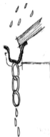
Figura 114. Cadena conducción aguas lluvias
