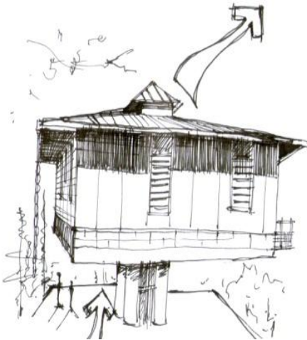
Figura 120. Ventilación por el piso.
