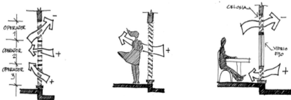
Figura 57 - 59. Permeabilidad de ventanas controlada según la actividad
