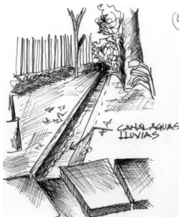
Figura 137. Cuneta de agua lluvias
