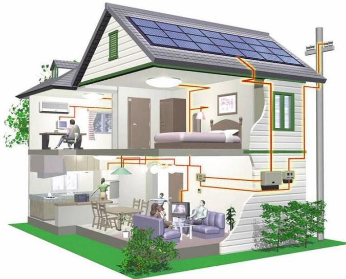
**Figura 14: Modelo del sistema interconectado a la Red con Contador Bidireccional**
