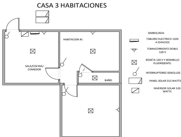
Para el sistema fotovoltaico de la vivienda de 3 habitaciones, necesita 2 módulos.
