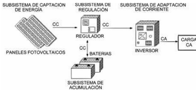
Figura 8. Elementos de un sistema Fotovoltaico.
