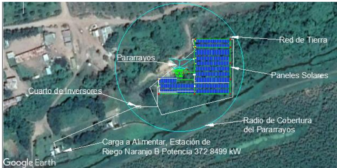
Figura 30: Cobertura de pararrayo tipo cebado
