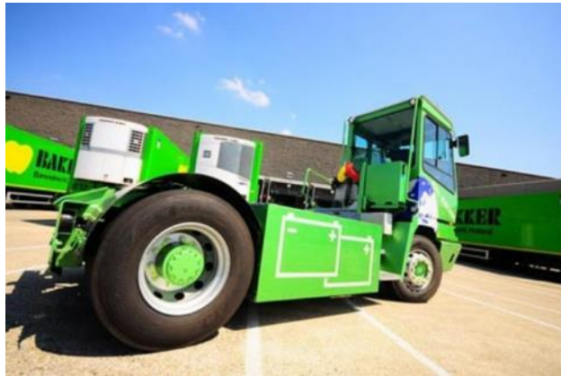
Figura 7 Terminal tractor 100% eléctrico
