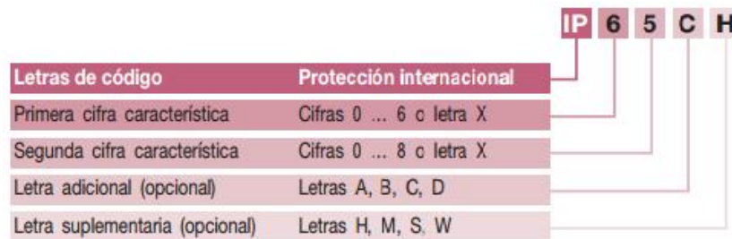
Figura 3. Nomenclatura del Grado de Protección Internacional
