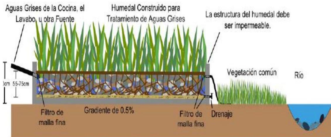
**Figura 11. Sistema subterráneo típico de humedales construidos**
