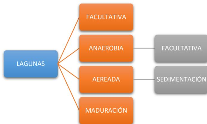
**Figura 13 Tipos de Lagunas de Estabilización**
