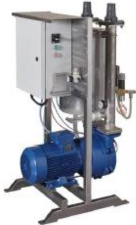
La bomba de vacío es un tipo llamado bomba de vacío de anillo líquido. Este tipo de bomba de vacío es muy confiable. La bomba usa el agua como sello entre el rotor y la carcasa en la bomba. Por ello siempre es necesario tener agua disponible para la bomba.
