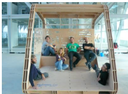
Ilustración 1. Mobiliaria definitivo de banco-pérgola-bancal fabricado en Laboratorio de Fabricación Digital
