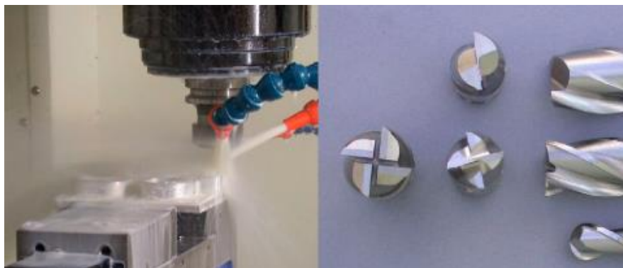
Ilustración 8. Fresadora CNC cortando aluminio (izquierda) y fresas de cobalto (derecha)
