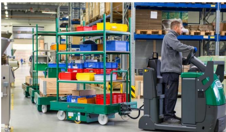
Ilustración 1 Sistema de movimiento de materiales, tugger y estructura metálica móvil, Vemag.
