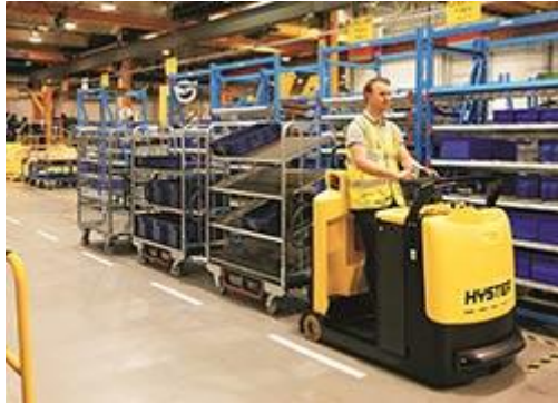
Ilustración 2 Sistema de movimiento de materiales, tuggger y estructura metálica móvil, Hyster
