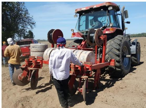
**Figura 27. Inyectado de Manguera de Goteo**
