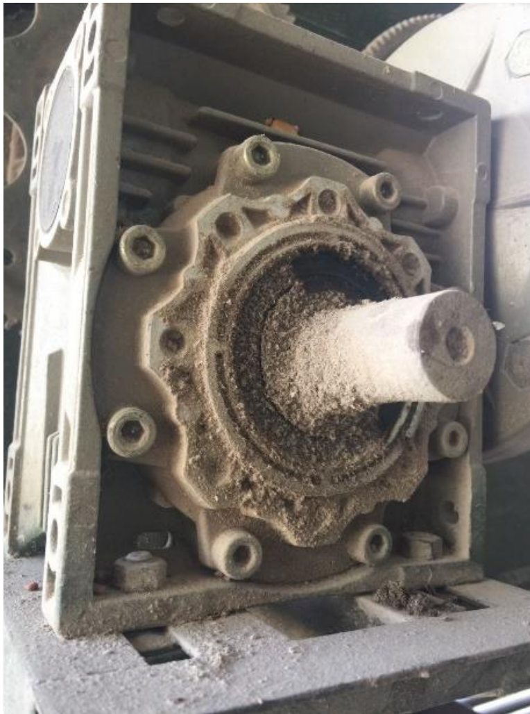
Figura 9. Situación actual suciedad equipos
