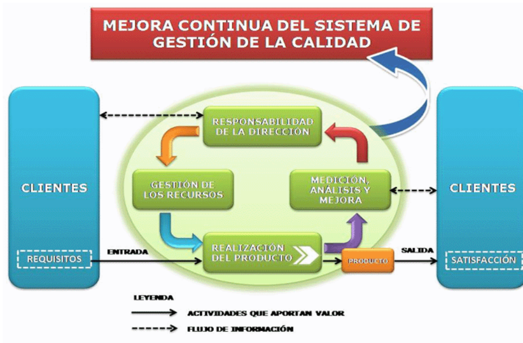
Figura 1. Modelo de sistema de gestión de calidad basado en procesos según ISO 9001
