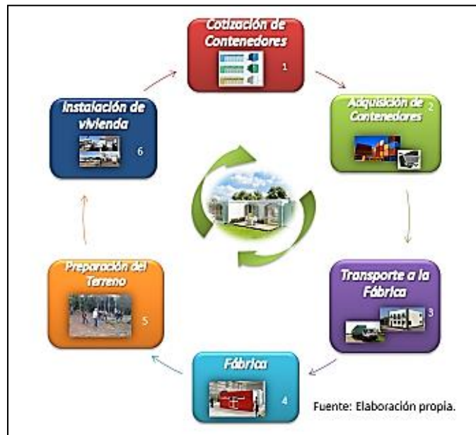
Figura 14. Proceso de Acondicionamiento del Contenedor
