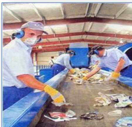
Figura 31. Proceso Manual de clasificación de residuos sólidos en banda transportadora.
