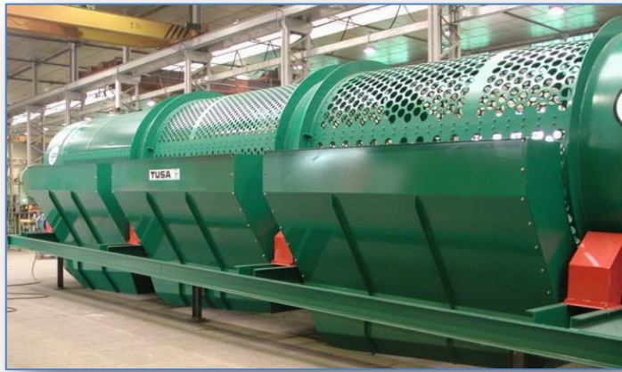
Figura 13. Tromel de Clasificación con 3 filtros de 12 m de longitud.
