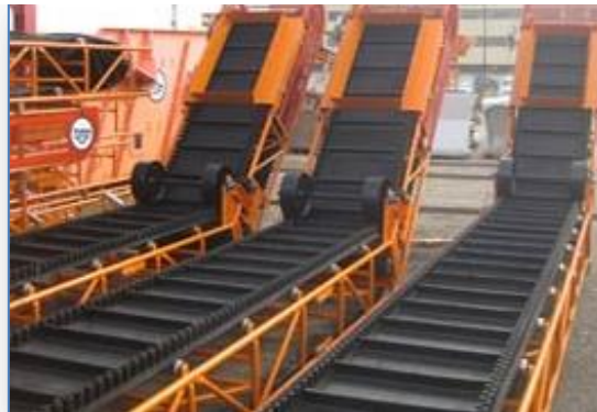
Figura 14. Banda transportadora de residuos
