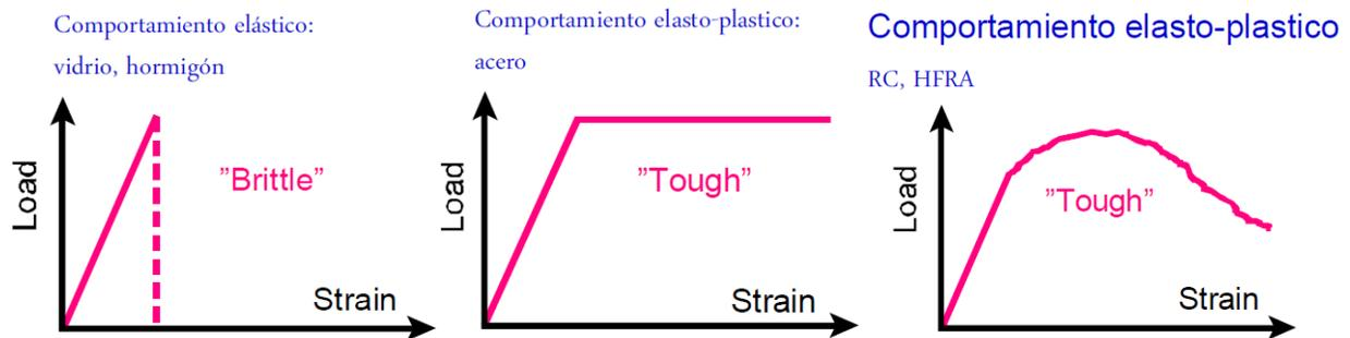
**Figura 8. Graficas esfuerzo - deformación de algunos materiales**
