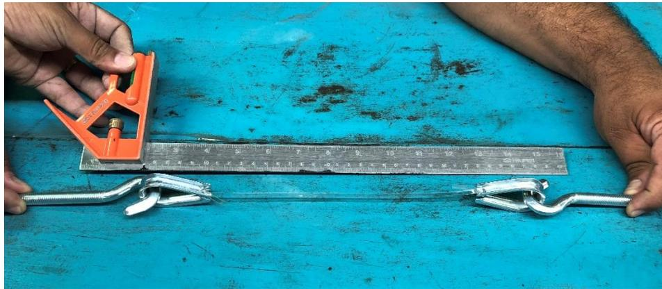
**Figura 41. Arreglo de la fibra PET reciclada para ser probada a tensión**
