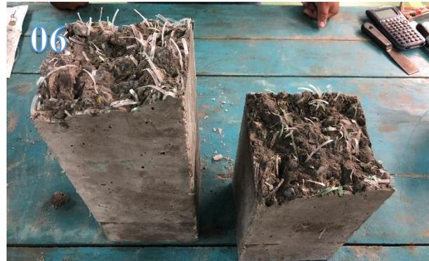
Vista de las fibras PET en las vigas de Concreto
