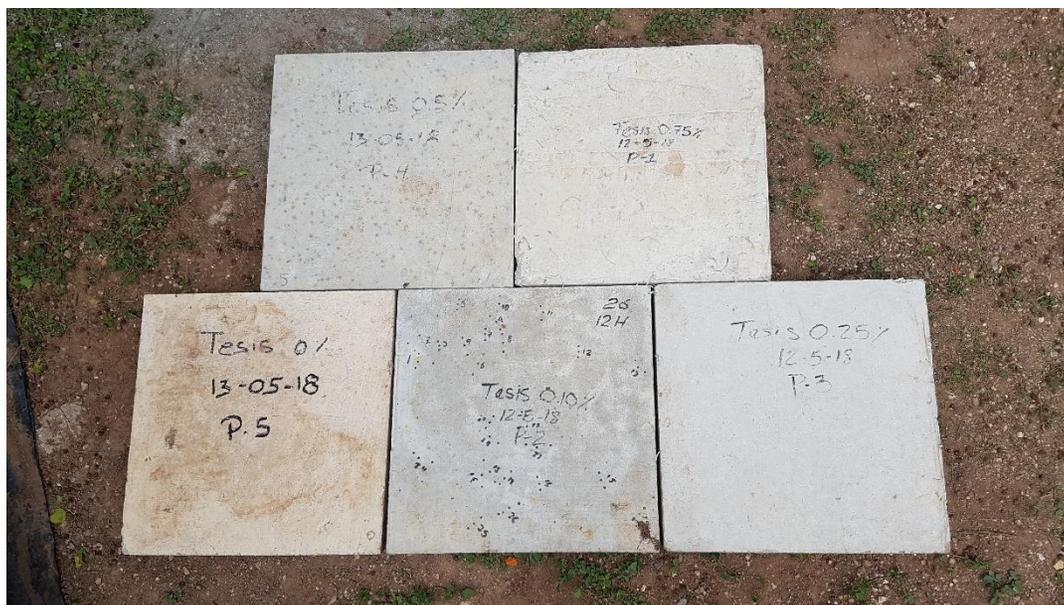
**Figura 59. Losa de concreto con diferentes porcentajes de fibra PET**
