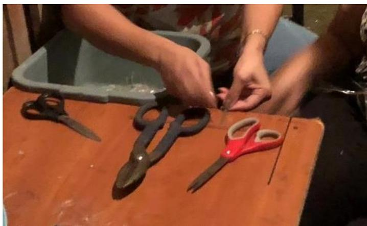
**Figura 39. Cortado de fibras PET recicladas a la longitud de 2 pulgadas**
