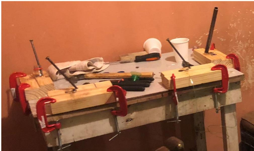
**Figura 35. Equipo artesanal para la fabricación de fibras PET**
