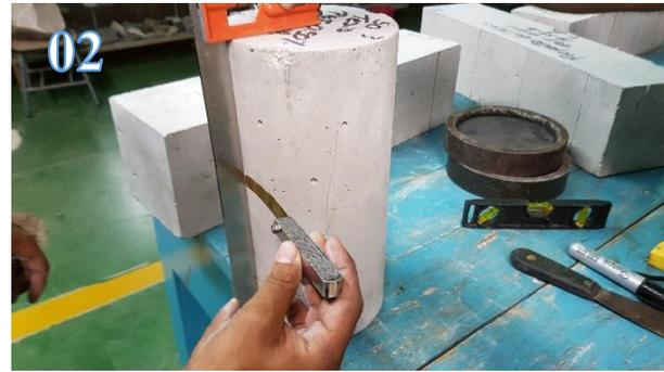
Se verifica la horizontalidad y verticalidad del cilindro de prueba
