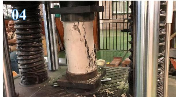
Se colocan los cabezales de neopreno y se realiza el ensayo, finalmente se verifica el tipo de falla según la figura 11 de la sección 2.3.3
