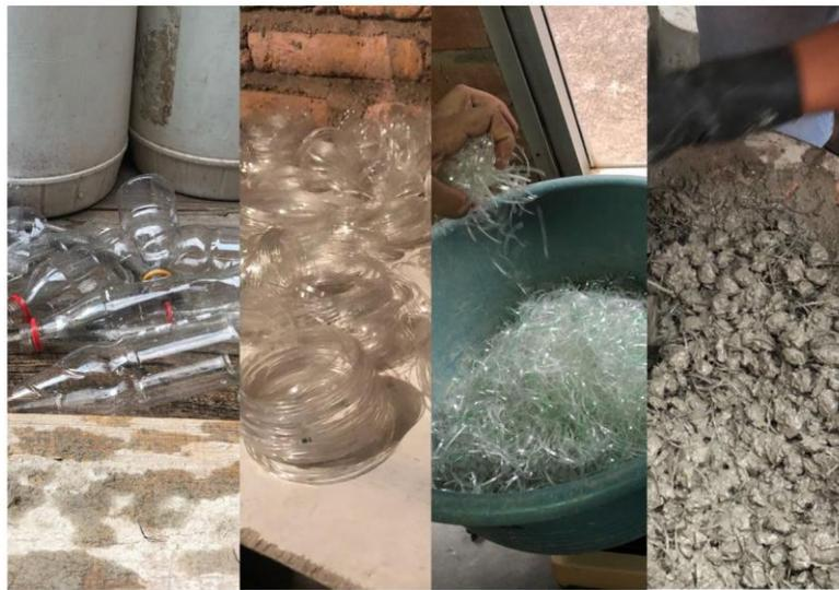
**Figura 74. Fibras PET recicladas de botellas de refresco**
