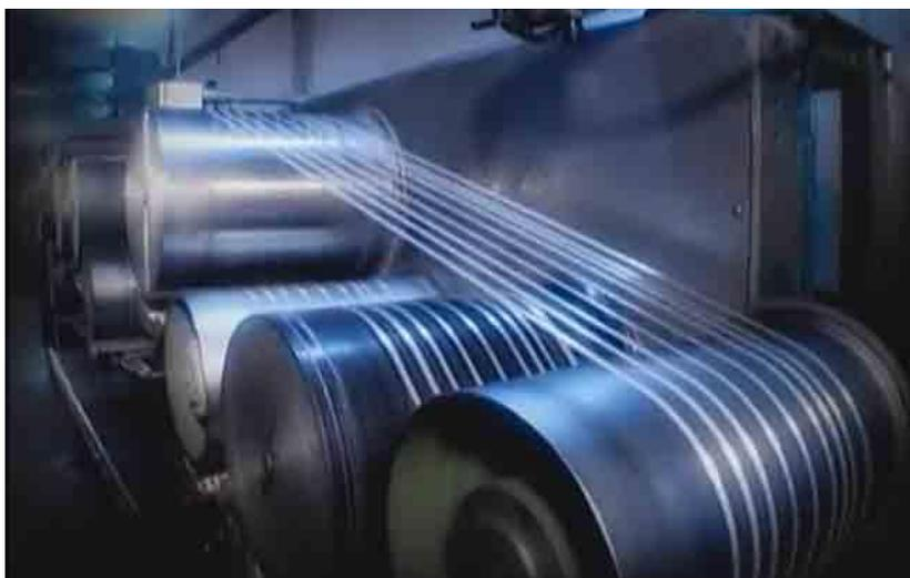
**Figura 3. PET convertido en fibras para elaborar cuerdas**
