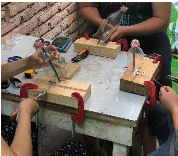
**Figura 37. Proceso de corte las botellas de refresco en tiras de PET**
