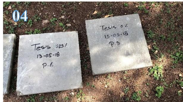
Luego de 12 horas se desmoldó la losa y se verificaron el número de grietas por contracción del fraguado
