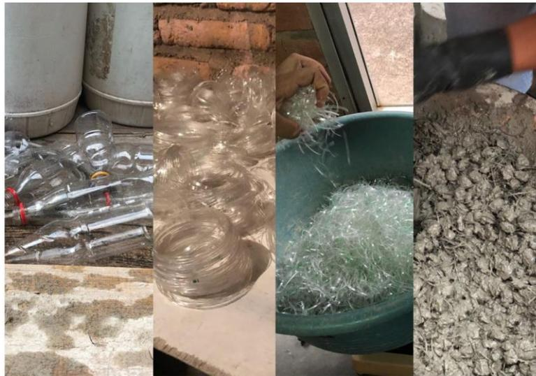
**Figura 72. Fibras PET recicladas de botellas de refresco**
