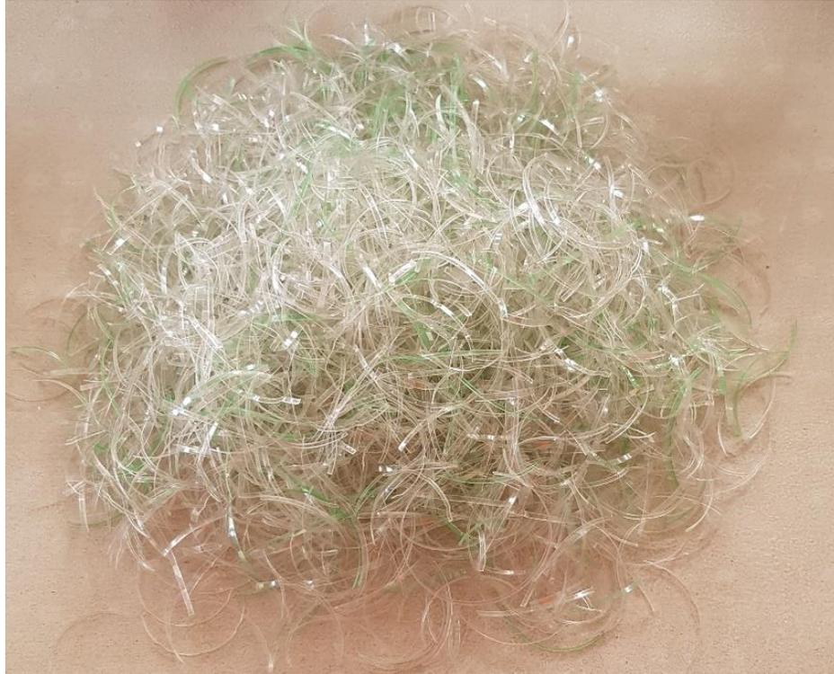
**Figura 6. Producto final, Fibras de PET reciclado de 2 pulgadas de longitud**
