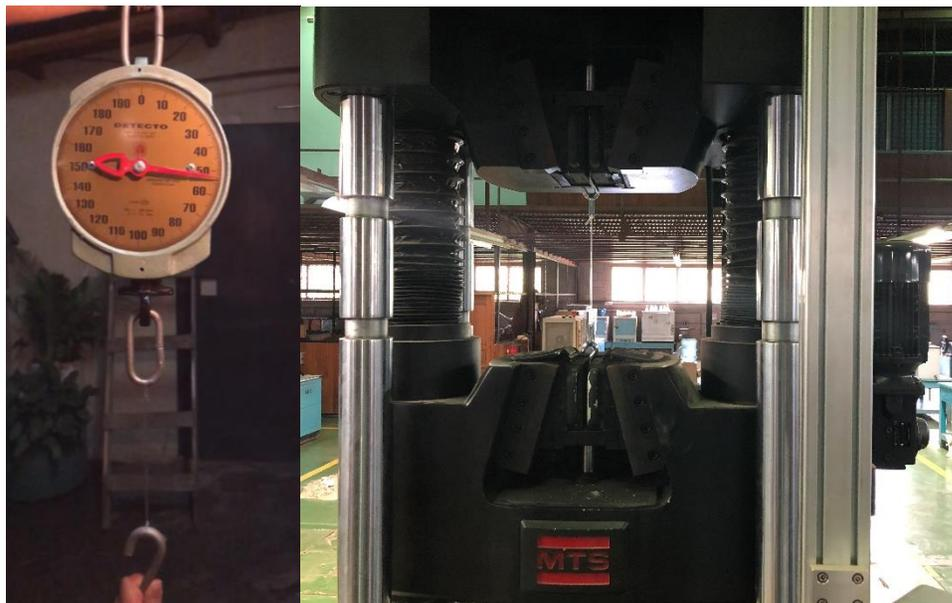
**Figura 42. Ensayos a tensión de la fibra PET reciclada**
