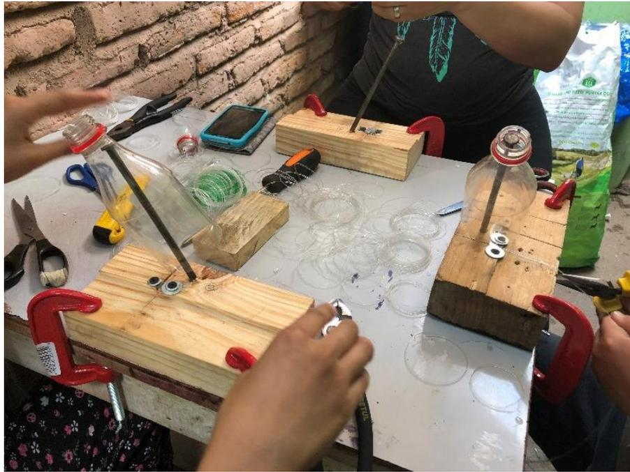
**Figura 4. Equipo de corte artesanal para la fabricación de fibra PET**
