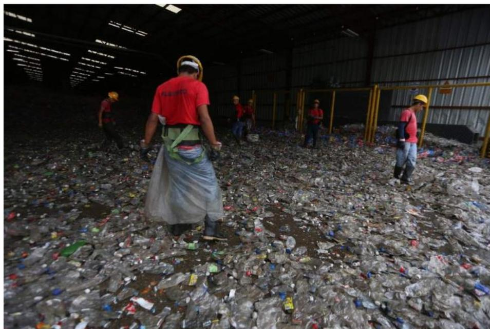
**Figura 11. Zona de Clasificación de botellas de PET, Planta INVEMA**
