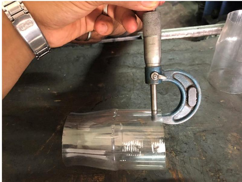
**Figura 36. Medición del espesor de PET de las botellas**
