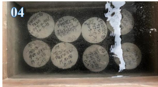
Una vez lleno el molde se retira y el cilindro se cura totalmente sumergido en una pila llena de agua
