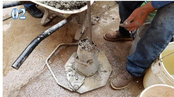
Ensayo de revenimiento con el cono de Abrams, se llena el cono en tres capas dando 25 golpes por capa
