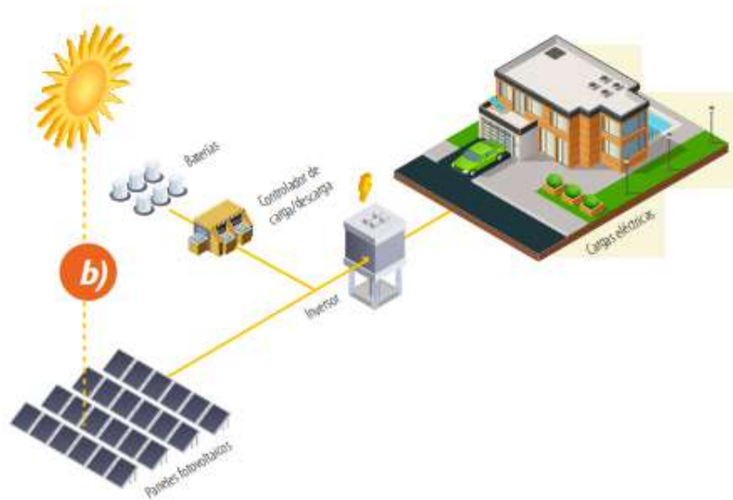
Figura 20 . Uso de inversores para almacenar energía en baterías
