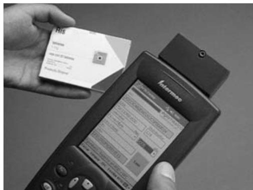
**Figura 6. Muestra de medicina con etiqueta RFID y lector de etiquetas**
