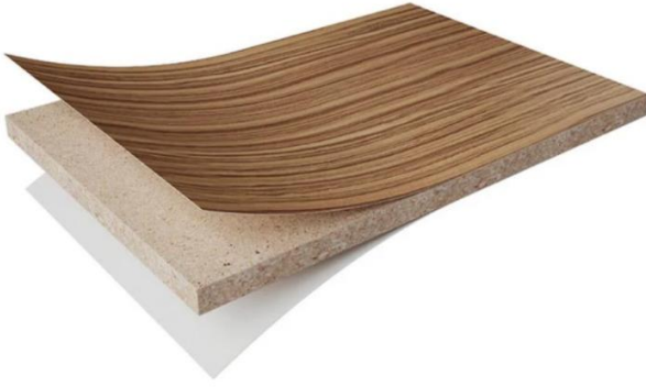
Figura 1 Tablero Cubierto con Melamina
