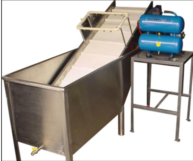
Fabricada completamente en acero inoxidable 304. Capacidad según necesidades del cliente (Requerimos una de capacidad de 1500kg).
