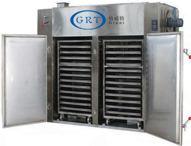
Serie tc-c de circulación de aire caliente seco o utiliza un bajo nivel de ruido de alta y la temperatura de la prueba de flujo axial del ventilador de un sistema automático de control de la temperatura del sistema. Todo el sistema de circulación es el completamente cerrado para hacer que la eficiencia de calor seco aumenta de 10% 15% - de la tradicional a 50% 65% - de la presente. La más alta eficiencia de calor puede llegar a 80%.
