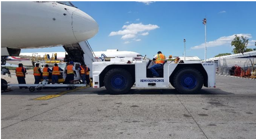
Figura 18. Pushback y barra lista para realizar acción de empuje del avión.
