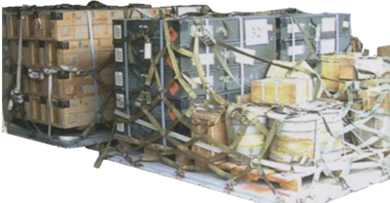
Figura 22. Posición armada con carga estibada en tarimas de madera y a granel.
