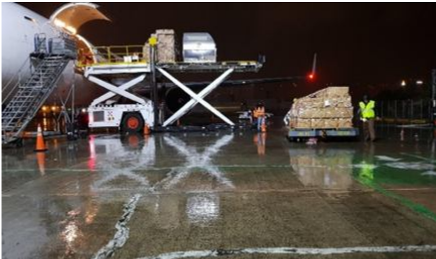
Figura 16. Pallet loader cargando posiciones de carga en el avión.
