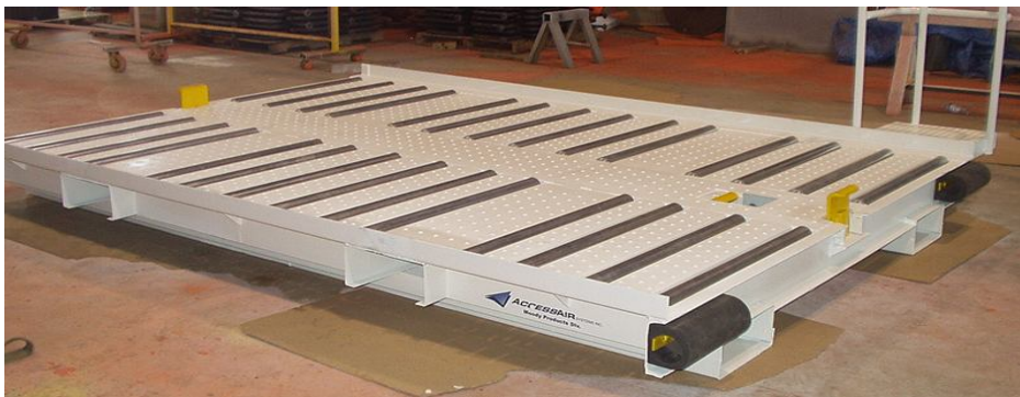
Figura 24. Slave pallet listo para movilización de pallets en montacargas.
