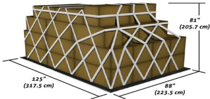
Figura 11. Posición enmallada de un avión con configuración 767.
