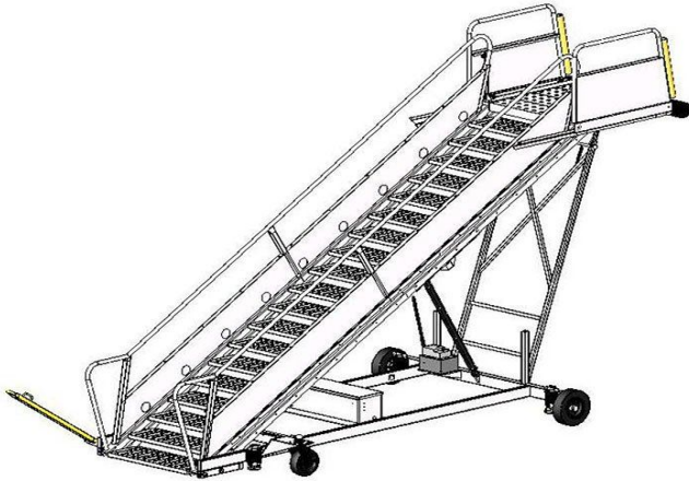
Figura 26. Escalera metálica para la tripulación.
