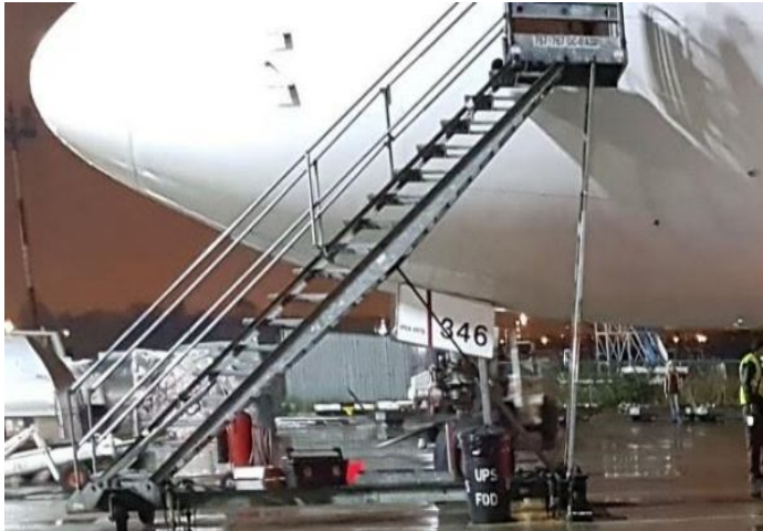
Figura 25. Escaleras posicionadas para el descenso de la tripulación del avión.
