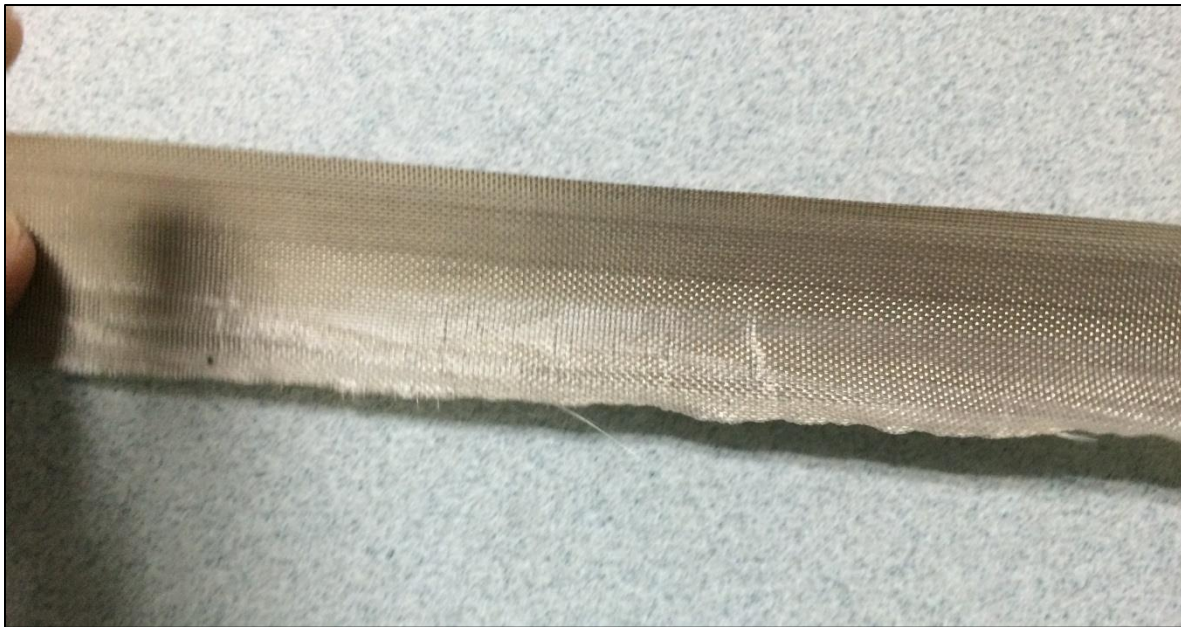
Bandas de Teflón dañadas debido a un mal ajuste de la inclinación en el sistema de compresión.
