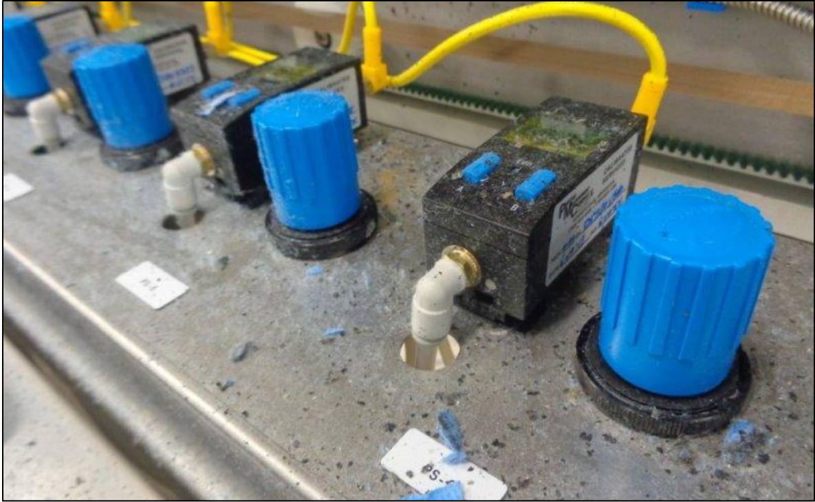
Sucio acumulado dentro de las máquinas selladoras.
