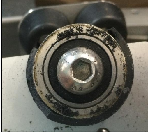
Rodo No Conforme
