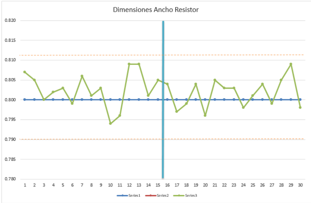
Ilustración 57. Tendencia de mediciones de ancho del resistor
