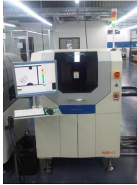
Ilustración 27. Máquina SPI (inspección de pasta para soldar)
