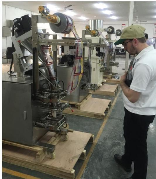
**Figura 17. Máquinas envasadoras automáticas de salsas**
