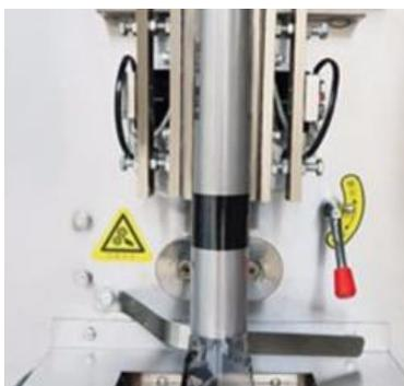
**Figura 20. Parte de sellado de bolsa vertical**
