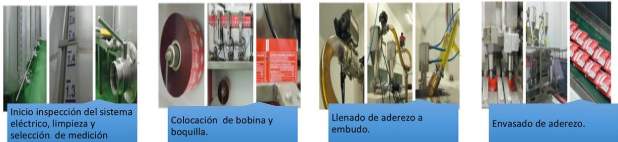
**Figura 11. Descripción paso a paso del proceso automatizado de envasado de aderezos.**
