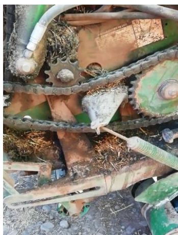
Figura 9. Recalentamiento por altas temperaturas del sistema de rodamiento (cadenas y balineras).
