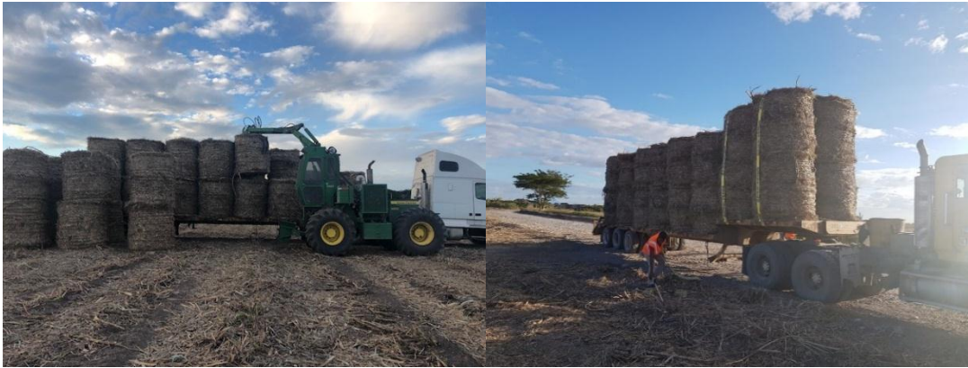
Figura 17. Alce de RAC con alzadora JD1800 y plataforma con capacidad de 32 (13 a 14 toneladas).
