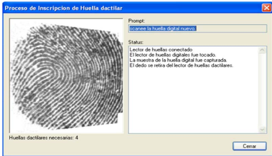
Figura 10. Proceso de inscripción de una Huella digital. Cortés Osorio, Jimmy Alexander; medina Aguirre y otros/ Proyecto de Grado, Sistemas de seguridad basados en biometría. Universidad Tecnológica de Pereira.
