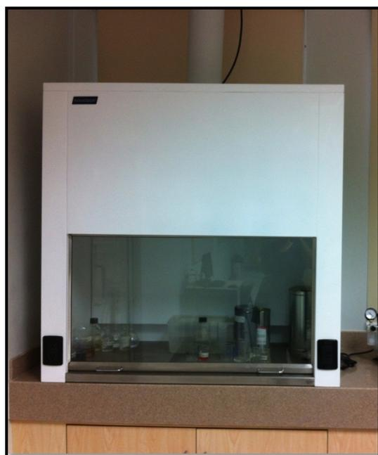
**Figura 13. Campana de extracción de gases**
