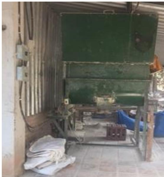
**Figura 12. Mezcladora vertical**
