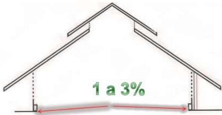
Anexo 10 Diseño de la inclinación recomendada para el piso de un galpón (Universidad de El Salvador, 2013)
