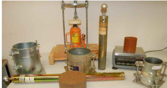
Figura 7. Equipo a utilizar para ensayo CBR
