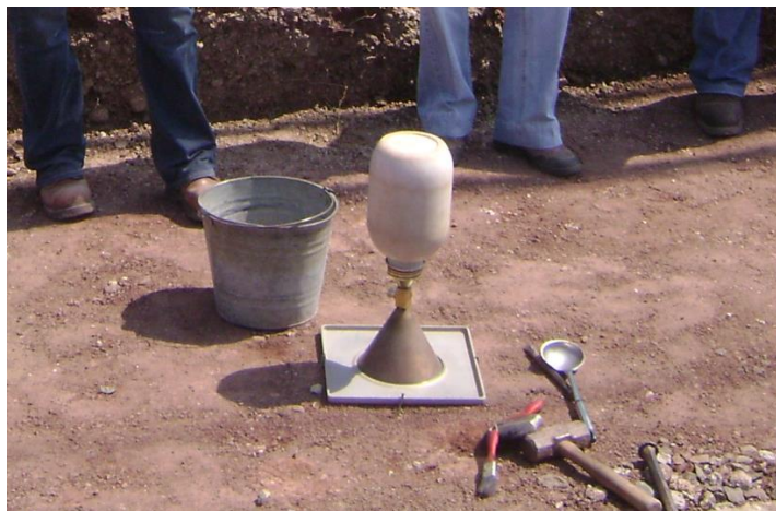
Figura 9. Ensayo de densidad en sitio
