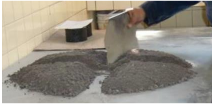
Figura 15. Cuarteado de material
