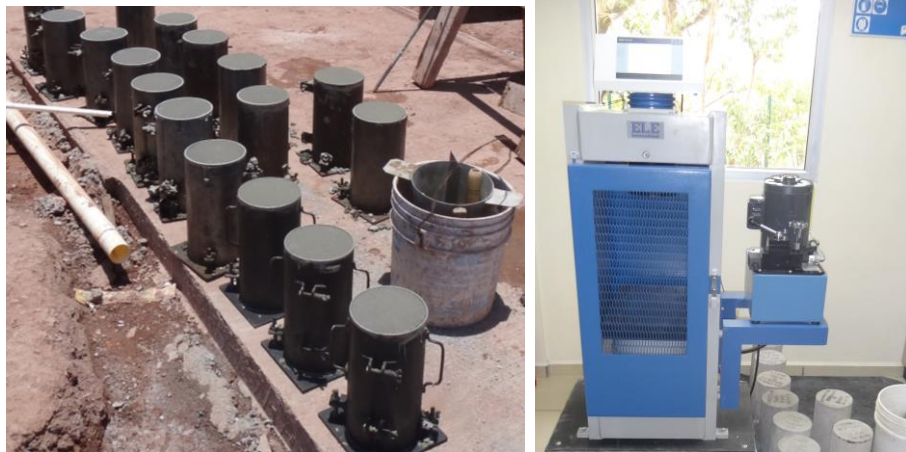
Figura 6. Moldes de concreto y máquina de prensa
