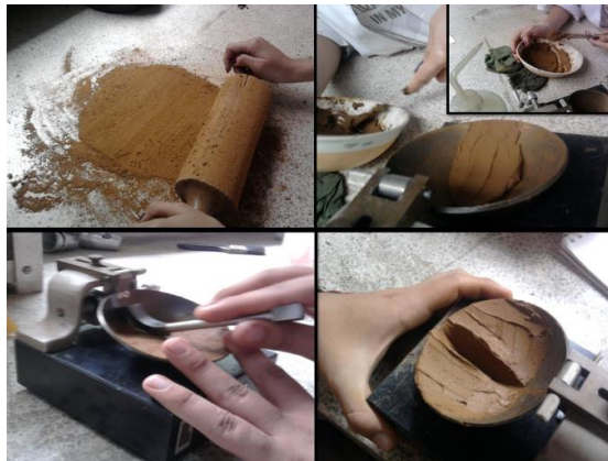
Figura 10. Ejecución de ensayos Límites de Atterberg
