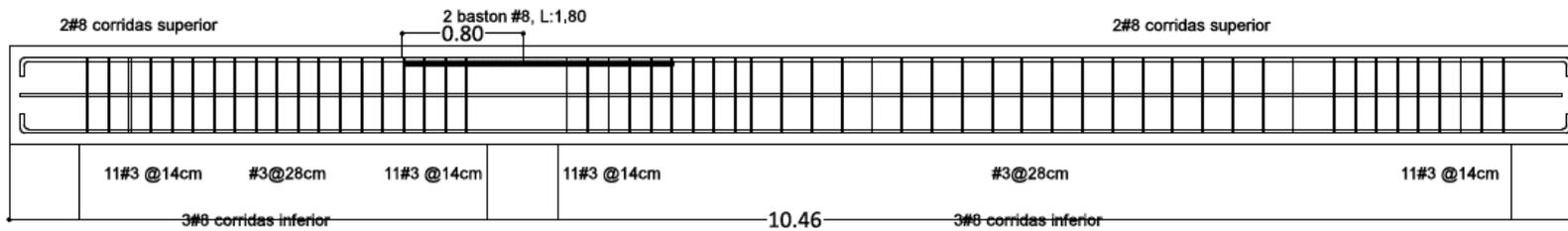
VIGA V-4a, SECCION 40X65
