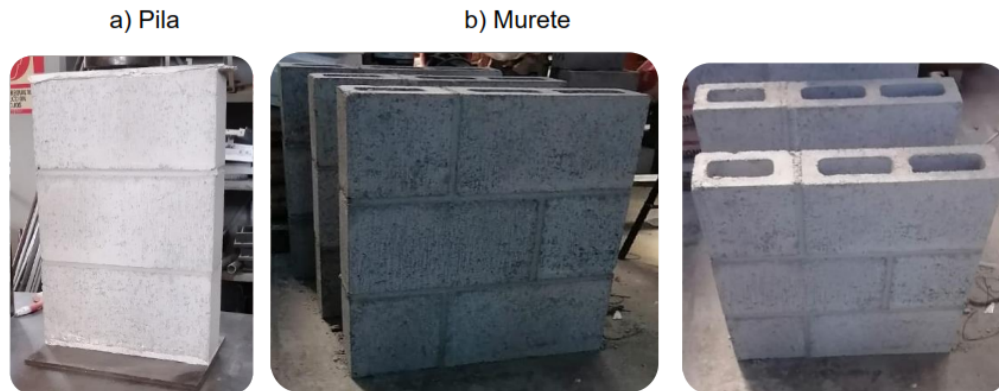
Figura 2. Probetas para ensayo a compresión y compresión diagonal de mampostería
