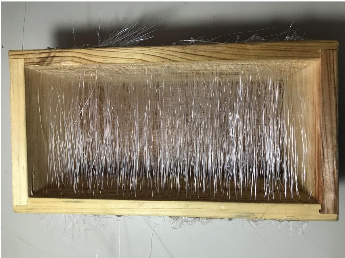
*Figura 22. Proceso colocación fibra optica*
