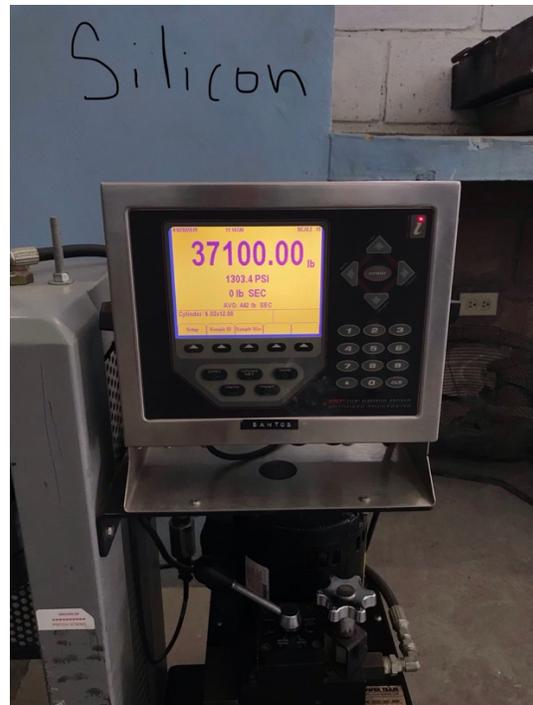
*Figura 34. Resistencia a la compresión (silicon)*
