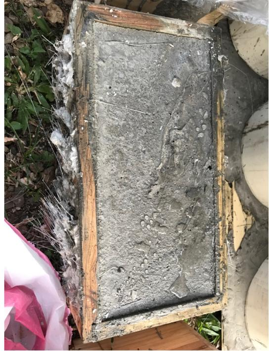
*Figura 24. Muestra con fibra optica*
