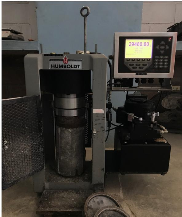
*Figura 33. Resistencia a la compresión (1:3)*
