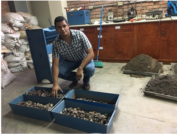
Cuarteo de las muestras a utilizar
