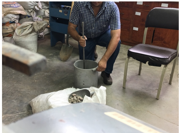
Pesos de los retenidos de los tamices y volumen compactado
