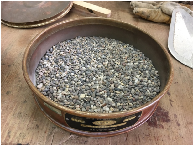
Granulometría por medio de tamices mecánicos
