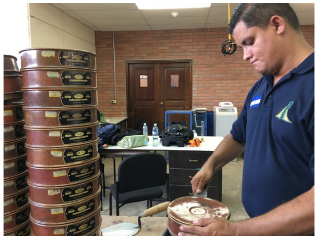
Granulometría por medio de tamices mecánicos
