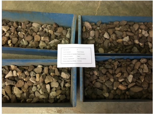
Cuarteo de las muestras a utilizar
