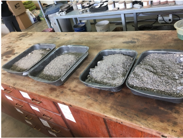
Lavado y secado de las muestras
