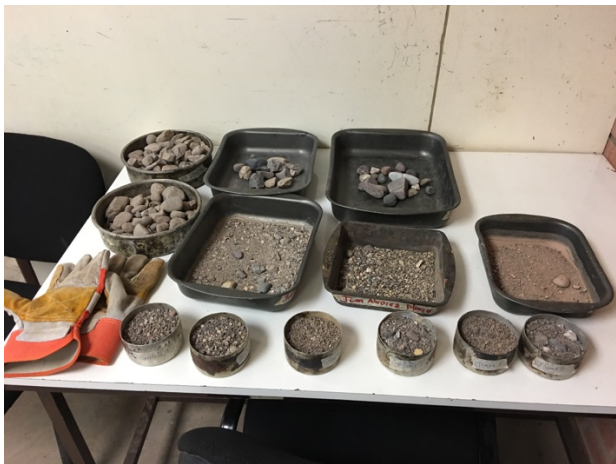
Pesos de los retenidos de los tamices y volumen compactado
