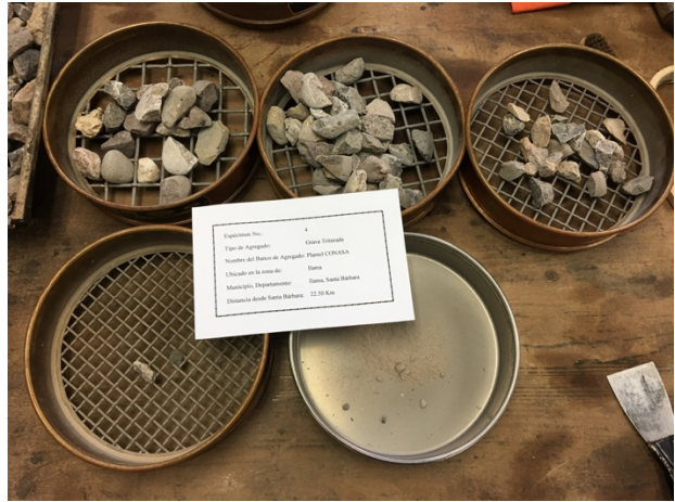
Granulometría por medio de tamices mecánicos
