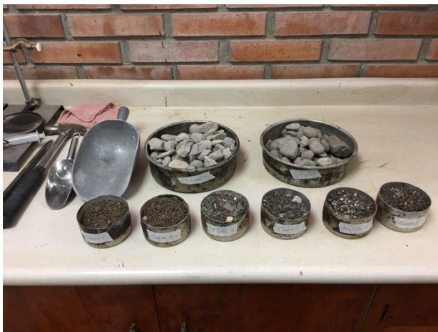
Granulometría por medio de tamices mecánicos
