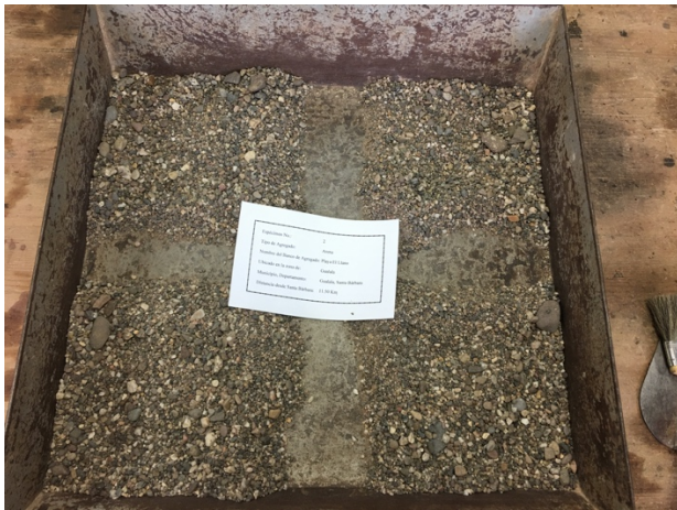
Nuevo cuarteo y secado de las muestras
