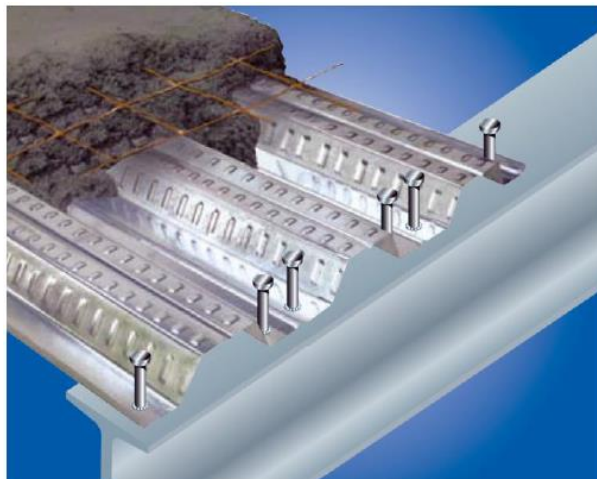
Figura 2. Sistema de losa compuesta con lámina colaborante.
