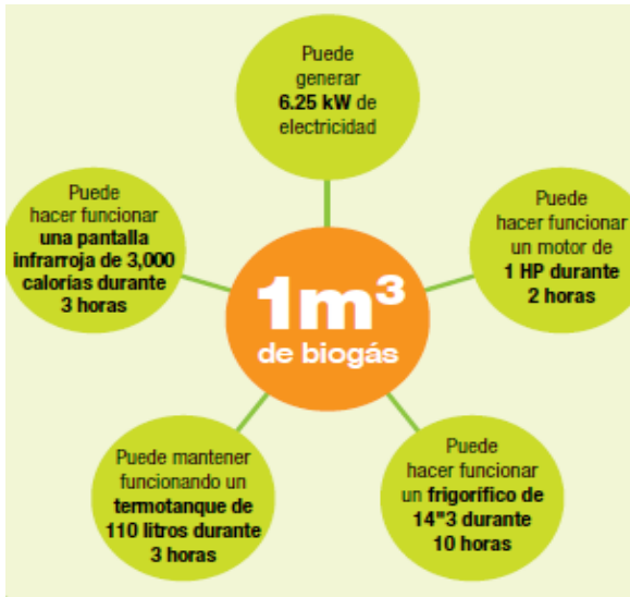
Figura 7. Alternativas de utilización de un metro cubico de biogás, con sus respectivos consumos.
