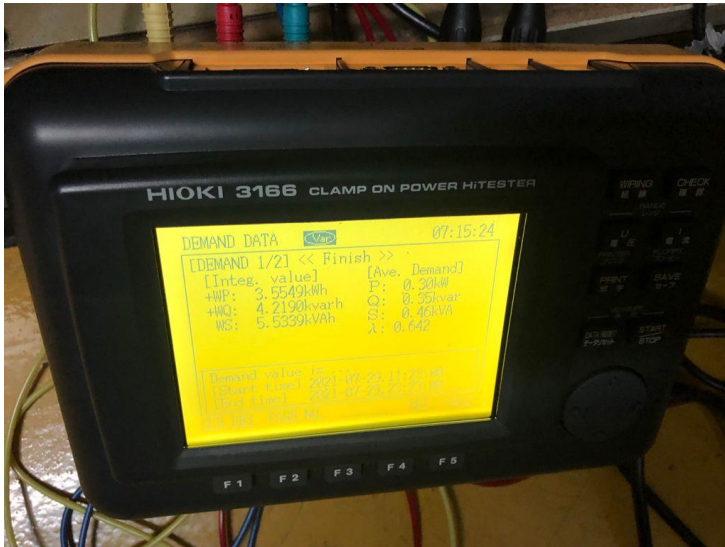
Figura 47. Analizador de red HIOKI 3166 clamp on power hi tester.
