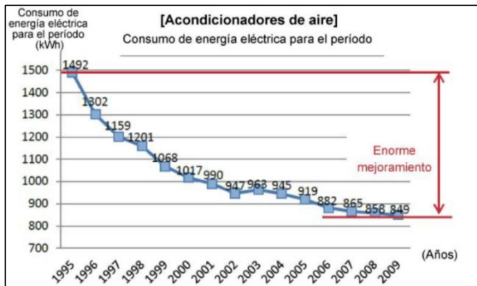
Figura 7: Consumo eléctrico de aire acondicionado residencial.
