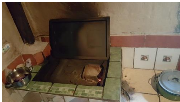
Fotografía No. 5 y 6: Estufas con modificaciones que no alteran su funcionamiento, por agregados de cerámica en el exterior.
