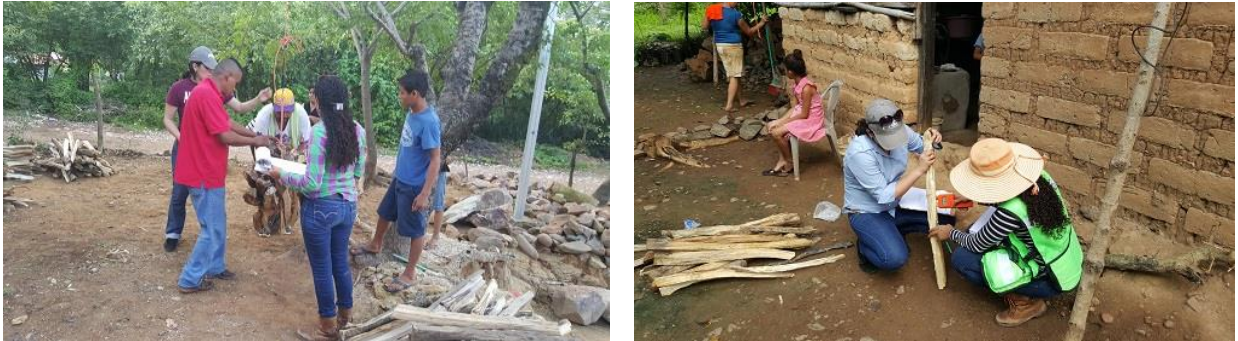
Figura 17 Peso y medición de la humedad de leña para aplicación de prueba KPT.
