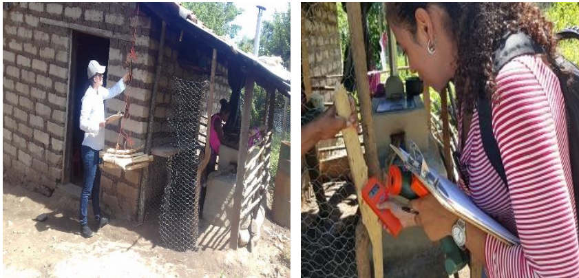
Figura 19 Medición del peso y de la humedad de leña para aplicación de prueba KPT.
