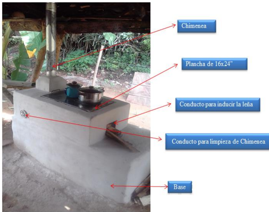
Figura 8 Componentes externos de la estufa Mejorada Justa.
