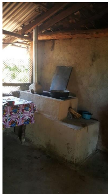
Fotografía No.11, 12 y 13: Estufas mejoradas construidas en los hogares que participaron en la evaluación del consumo de leña a través de la prueba KPT.
