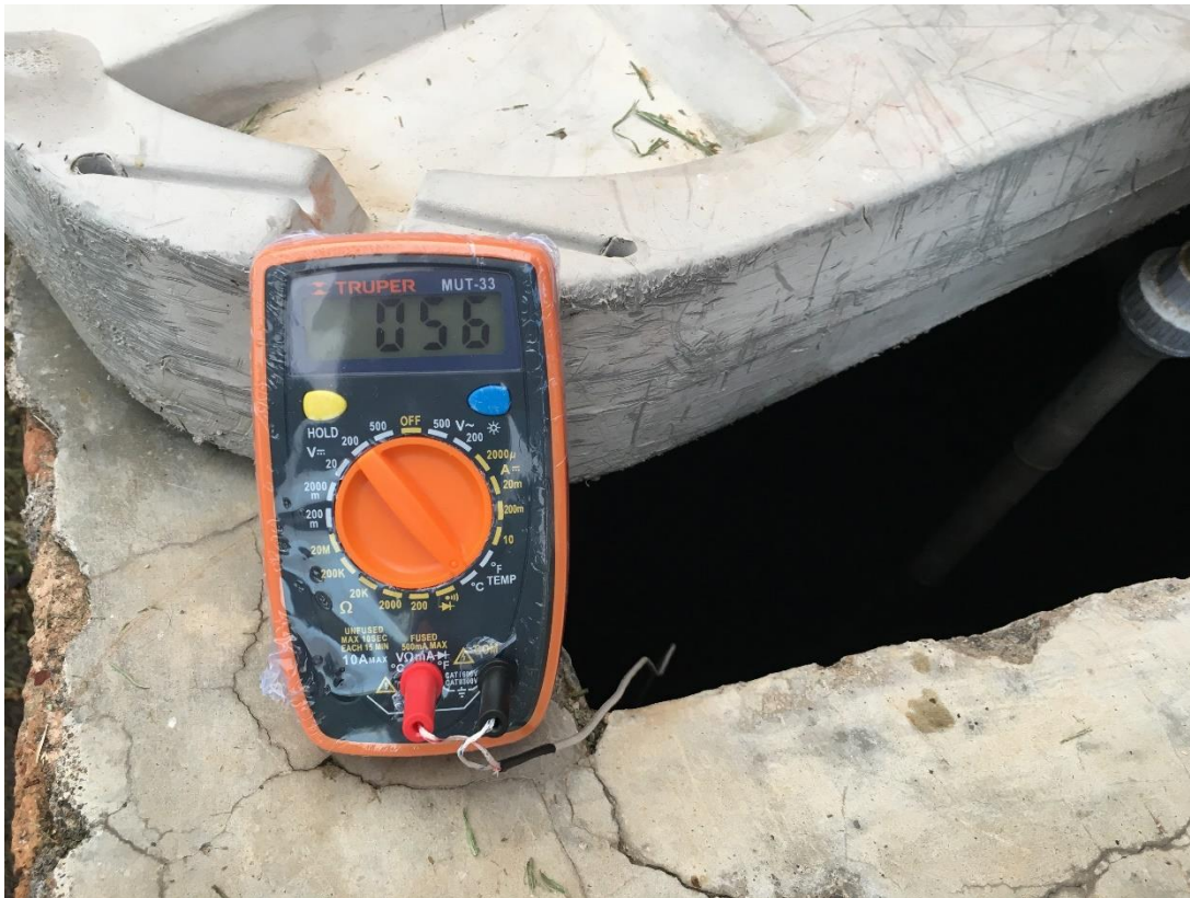
Toma de temperatura de un pozo malacate al lado de la industria láctea
