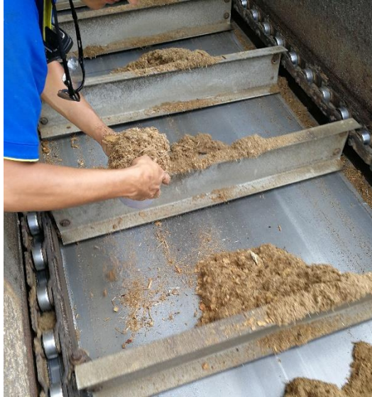
Anexo 6: Punto de toma muestra del bagazo en el conductor de alimentación.
