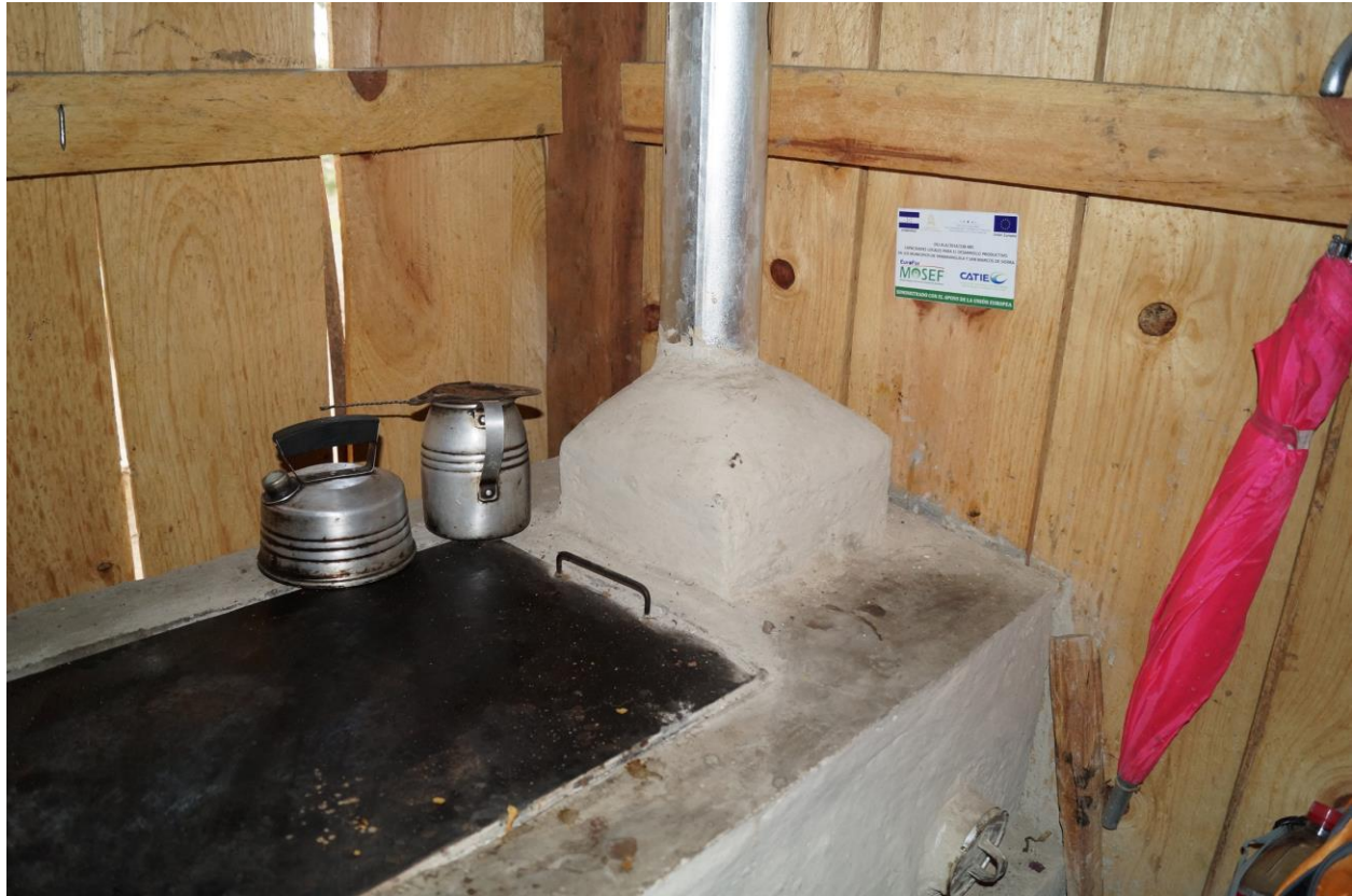
Figura 23 Eco estufa tipo justa euroFor MOSEF
