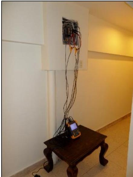
Se conectó el analizador de redes en la L1, L2, Neutra y Línea de tierra para tomar los valores de nivel de tensión (voltaje), corriente eléctrica (amperaje), potencia, energía y factores de potencia. Es importante destacar que la alimentación de energía del equipo, no tiene ningún aparato conectado y es exclusiva para el aire acondicionado.
