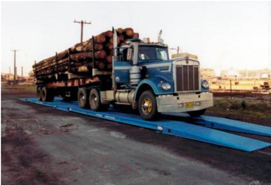
**Ilustración 11. Báscula que determina la cantidad de biomasa que ingresa a la planta**
