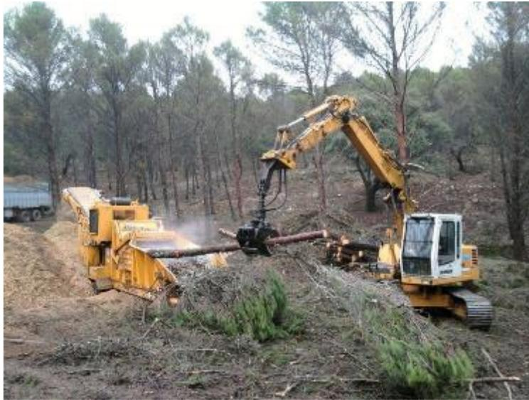
**Ilustración 9. Chipiadora móvil para transformar la biomasa en combustible**
