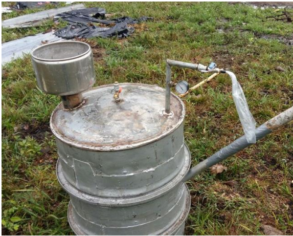
Anexo #8: Extracción de Biogás.
